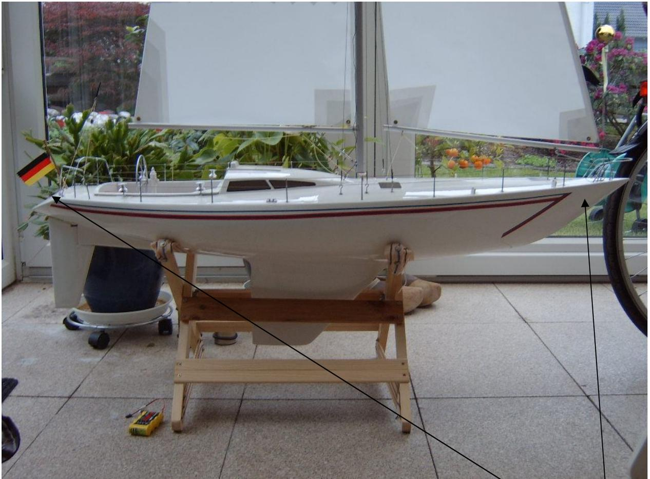
So sieht sie jetzt aus. Relingstützen, Körbe und Salingrohre verchromt, alle MS-Teile Alufarben lackiert, die Reling aus Edelstahllitze – nur der Namenszug fehlt noch: **albatros** so wird sie getauft !
