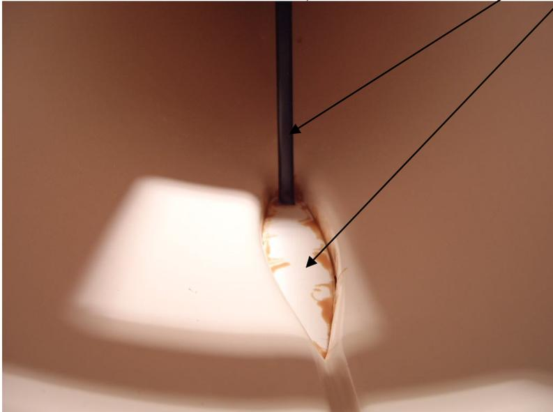
**Als nächstes, lt. Bauplan, kommt das Ruder mit dem entsprechenden Rohr (Ruderkoker) in den Rumpf. Hierzu wird das erforderliche Loch stufenweise gebohrt.**
