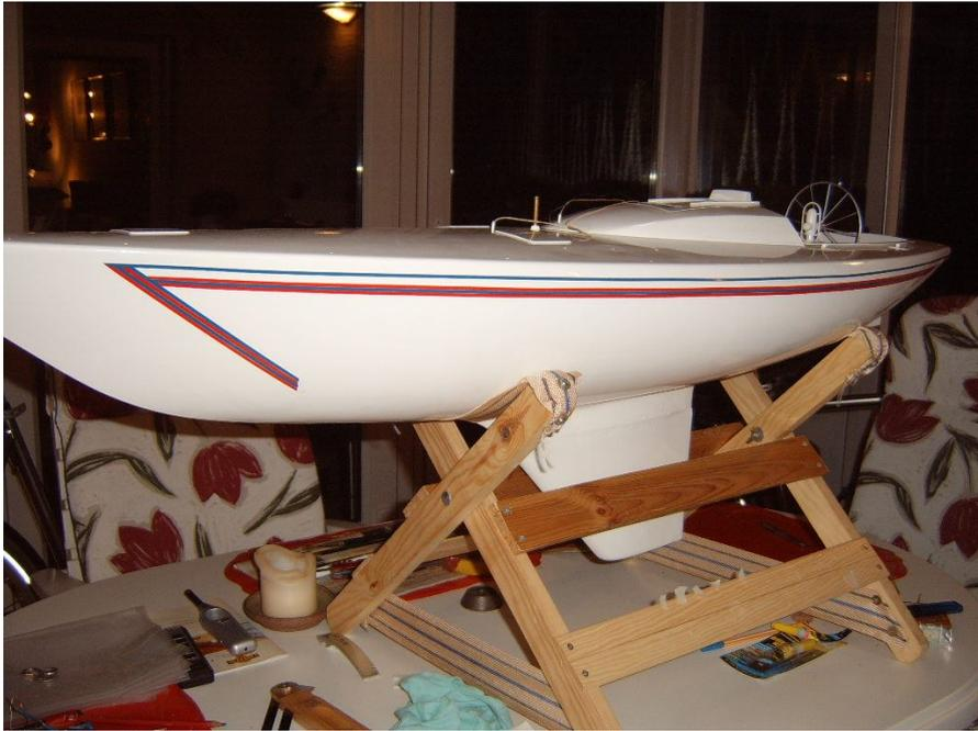
Nachdem ich viele Überlegungen angestellt habe: Wasserpass : ja oder nein ? Welches Finish überhaupt ? Lackieren oder kleben ? Unterwasserschiff so lassen oder blau lackieren ? So ist der Rumpf nun geworden, mit geklebten Streifen, 3 mm breit, rot und blau, aus dem Autozubehörhandel. So bleibt er erst mal, der Rumpf.
